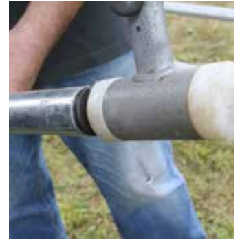
Schritt 6: Die Schutzkappen in die Öffnungen der Panels pressen. Bitte nicht in die Löcher für die Dachbögen. Wenn Sie hier unsicher sind, pressen sie die Abdeckkappen erst zum Schluss ein. .
