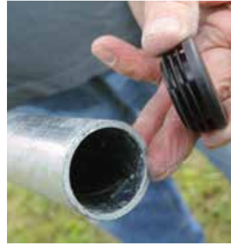
Schritt 6: Die Schutzkappen in die Öffnungen der Panels pressen. Bitte nicht in die Löcher für die Dachbögen. Wenn Sie hier unsicher sind, pressen sie die Abdeckkappen erst zum Schluss ein. .
