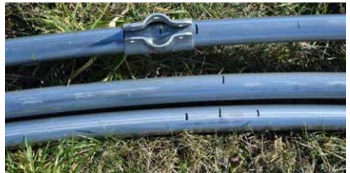
Schritt 8: Markierung aller Schellenpositionen. Die Abstände sollten gleich sein. Die unteren Druckstangen sollten ca. 45cm vom Panel entfernt sein. (Siehe auch 15).
